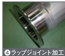
④ ラップジョイント加工
