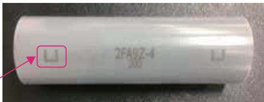
継手差込代マーキング
