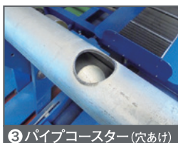
③ パイプコースター (穴あけ)
