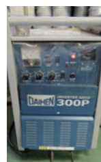
手動溶接機 (TIG) 11台 口径： 20SU~300SU (15A~300A) ※日本製
