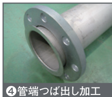
④ 管端つば出し加工
