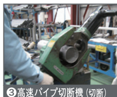
③ 高速パイプ切断機 (切断)
