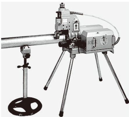
転造溝付け機 (ロールグラーパー) ライトグループ150DX
