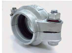
SUSタイプ (ボルト・ナットはSUS) 32A～100A ; 2MPa以下用 125A～150A ; 1.5MPa以下用 耐塩素EPDM SUSワッシャー 32A (40su) ～150A (150su)
