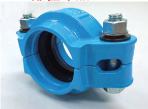
エポキシタイプ (ボルト・ナットはユニクロ) 50A～100A ; 2MPa以下用 125A～150A ; 1.5MPa以下用 耐塩素EPDM 黒ワッシャー 50A (60su) ～150A (150su)
