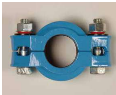
エボキシタイプ（ボルト・ナットはユニクロ） 25A～100A；2MPa以下用 125A～150A；1.5MPa以下用 耐塩素EPDM 黒ワッシャー エボキシタイプ（ボルト・ナットSUS）は非在庫品
