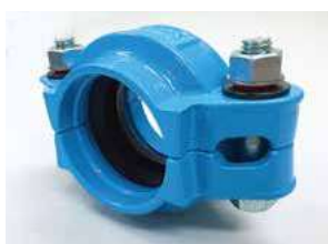
エボキシタイプ（ボルト・ナットはユニクロ） 50A～100A；2MPa以下用 125A～150A；1.5MPa以下用 耐塩素EPDM 黒ワッシャー 50A (60su)～150A (150su) エボキシタイプ（ボルト・ナットSUS）は非在庫品
