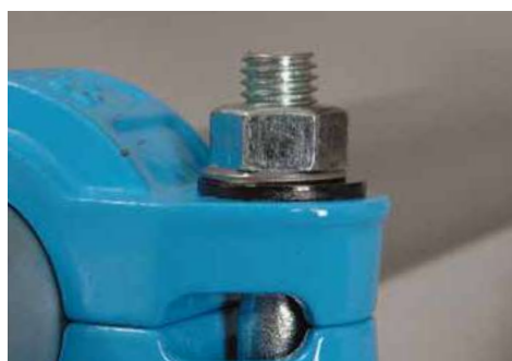
8 皿ワッシャーの赤色が見えなくなったら締め込み完了。
