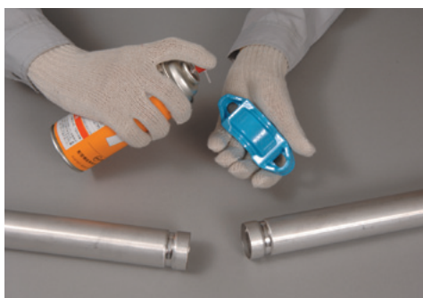
1 ハウジングの内面に潤滑スプレーを散布する。
