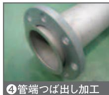
④ 管端つば出し加工
