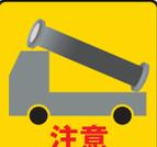
塩ビ部分が亀裂が生じますので、強いショックを与えるような取り扱いや運搬はしないでください。
