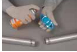
1 ハウジングの内面に潤滑スプレーを散布する
