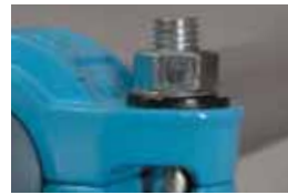
8 皿ワッシャーの赤色が見えなくなったら締め込み完了
