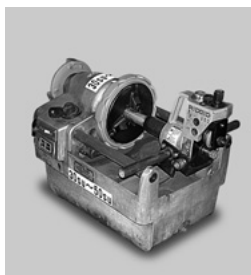
ネジ切り機搭載型960グルーバー ネジ切り機にRIDGIDグルーピング加工機が搭載済みの為、現場到着後すぐに使用出来ます。
